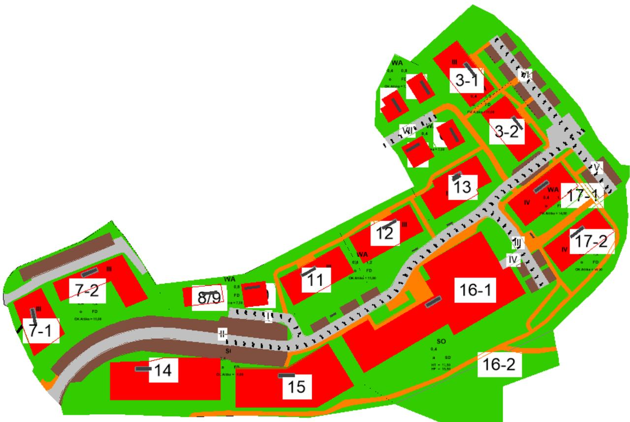
Abb. 2: Auszug aus der Flächeneinteilung zur Ermittlung des Versiegelungsgrads
